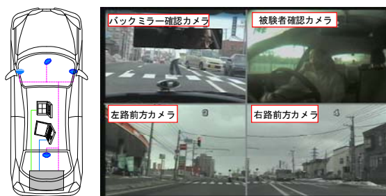
図16 運転挙動測定車とビデオ同期データ
