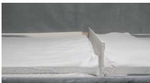
写真1 吹きだまり実験状況
