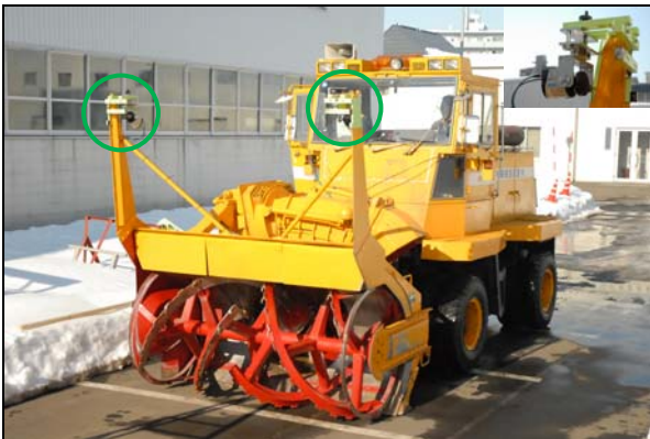
図-34 ロータリ除雪車に装着されたレーザースキャナ(丸印)
