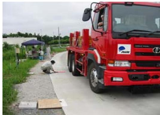
写真-4 静的載荷試験状況
