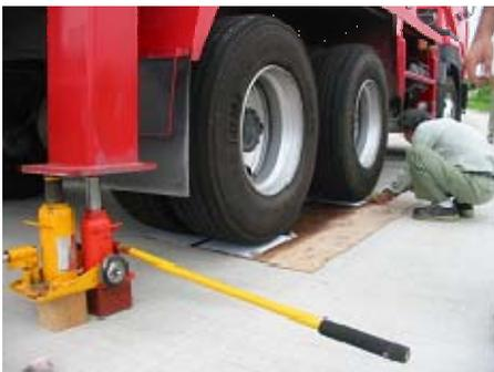
写真-3 タイヤ接地面積測定状況
