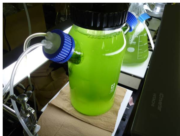
写真-5.10 半連続式反応槽の様子（実験 18 日目）
