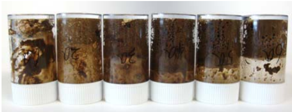
写真-3 泥炭、イースト菌の量を一定とし、シリカの量を変化させた例 (岩見沢:養生1日後)
