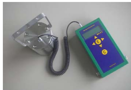
写真-8 動的平板載荷試験器
