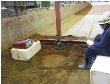
写真-10 平板载荷試験状況
