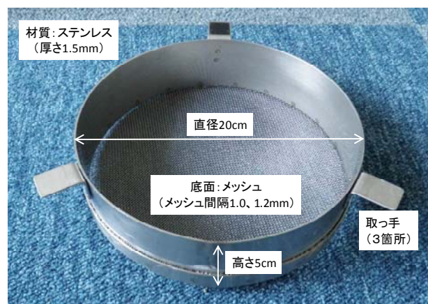
図1 観測に用いた融雪パンと蒸発パン
