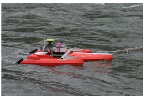
図-4 ADCP 観測に用いた橋上操作艇
