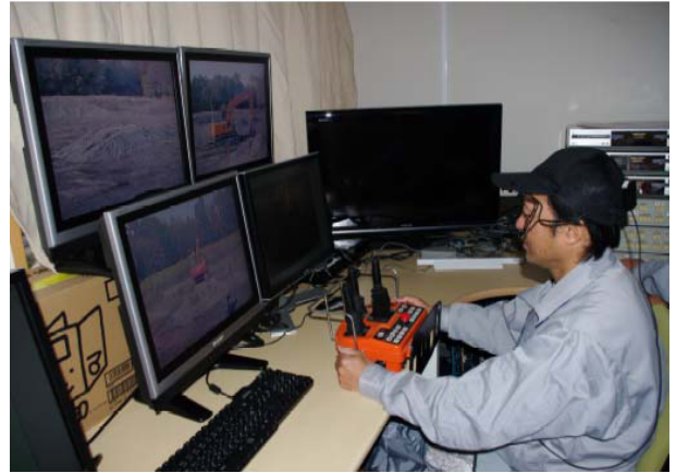
写真-4 遠隔操作システムによる操作
