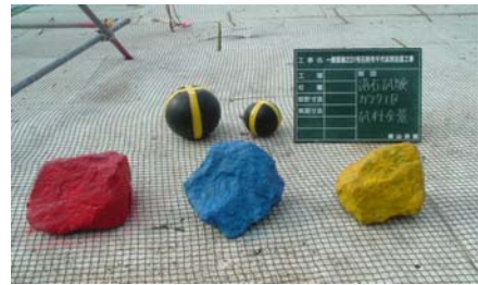
写真-1 現地実験の落石岩体試験体
