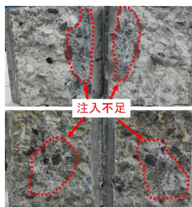
注入不足の供試体例
