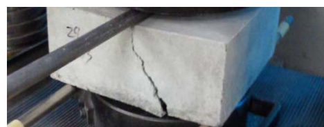
写真-1.2 ケースCの斜めひびわれ発生状況
