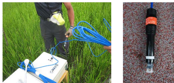
写真-4 Ehメータの設置状況とセンサー
