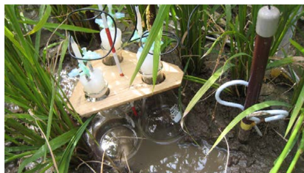
写真-5 土中水採取状況
