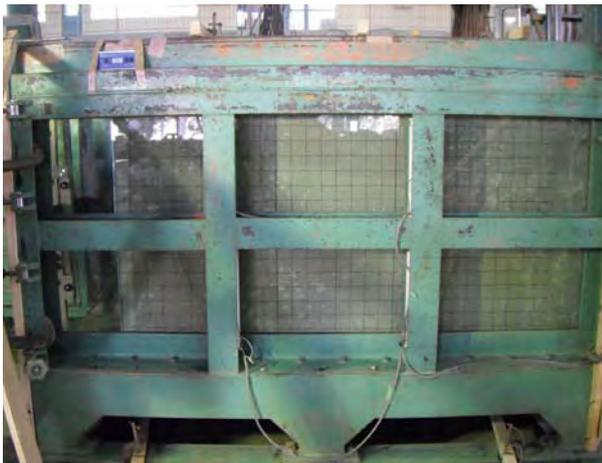
写真-1 補強土壁模型
