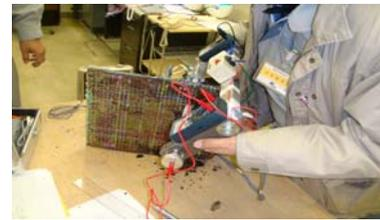
写真-2 電気抵抗検知式厚さ計による残存板厚計測状況
