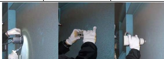
写真-1 付着塩分計測状況
