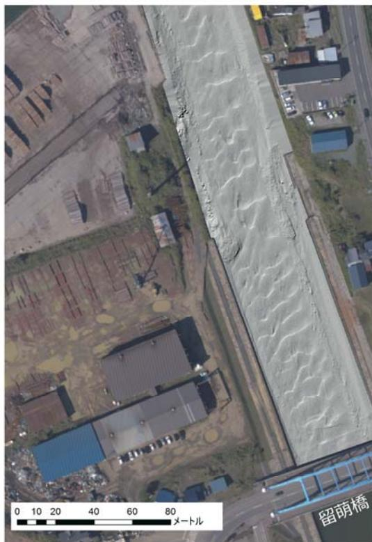
図 - 4.4 留萌開発建設部によるマルチビーム測量観測結果 (2011年12月14日) 標高値陰影図
