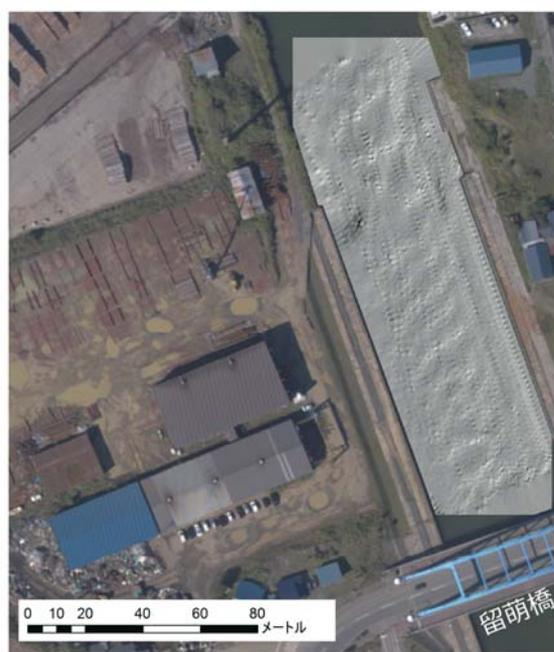
図 - 4.1 HDS-8 による観測結果(2011 年 12 月 8 日)を基に IDW 法を用いて補間することで得られた河床標高コンター：上図 session1、下図 session2
