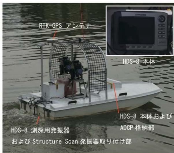
写真 - 3.1 観測時のRCボートの様子
