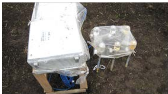
写真-3 テンシオメータ設置状況
