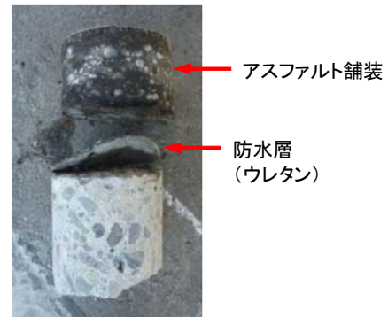
(b) 削孔中に分離したコアの側面の状況（T1-L5）
