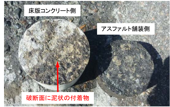
(a) 削孔中に分離したコアの破断面（T1-L2）
