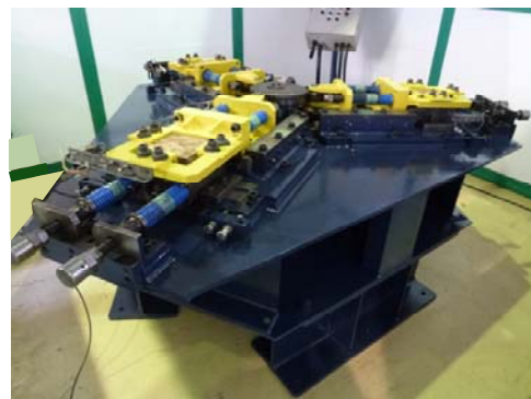
図-15 せん断疲労試験機の全景
