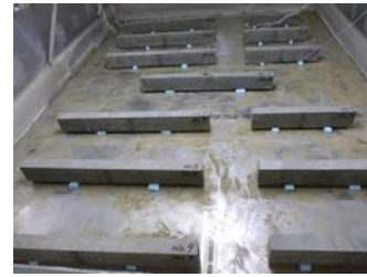
図-6 凍結融解装置内部の小型RC梁配置状況
