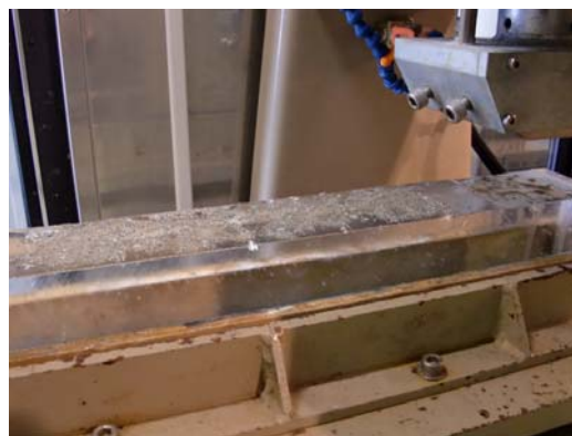
図-8 氷の表面に砂をセットした状態
