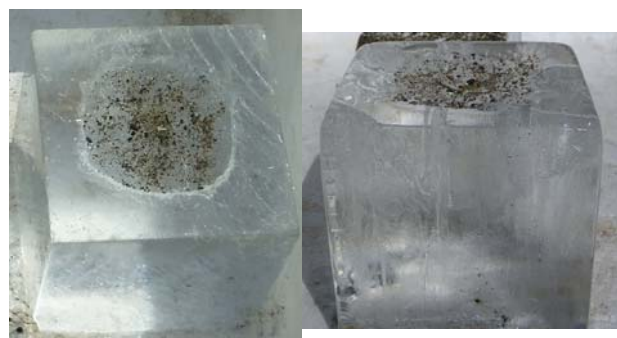
図-5 試験氷表面への砂散布直後(左)と暴露 60 分後(右)の状況
