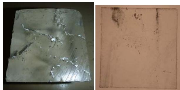
図-6 表層部除去後の横断面(左)と縦断面例(約 2cm にスライス)
