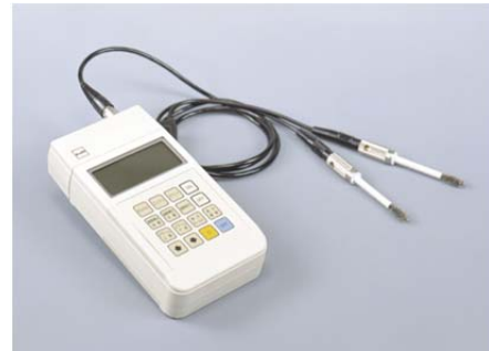
写真-1 電気抵抗式モルタル・コンクリート水分計
