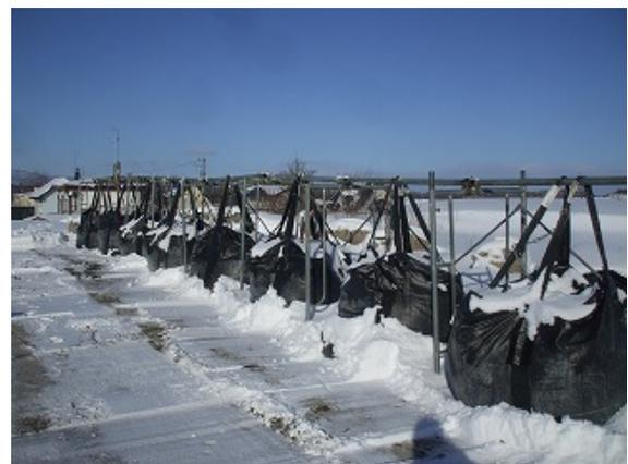
写真-5 大型土のうによる含水比低下実験状況
