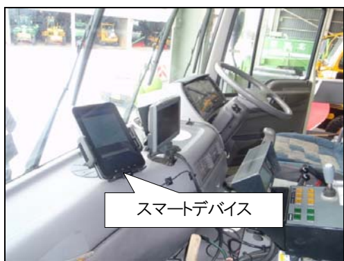
写真-1 スマートデバイス搭載状況 (除雪トラック)
