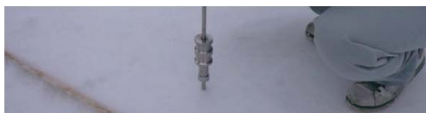
写真-2 雪硬度の測定状況
