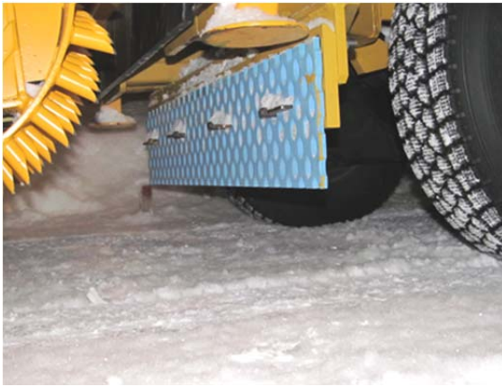
写真-8 氷板・圧雪路面処理装置エッジ部
