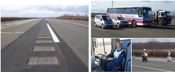
写真9 大型車対応規格のランブルストリップス(左)と主観的評価試験の様子
