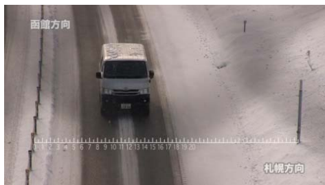
写真7 通過位置の測定状況
