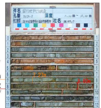
図-7 地すべり斜面下部の地質状況 (BV-24-8)
