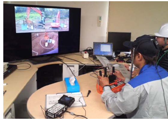
写真 5 操作状況 (遠隔操作)
