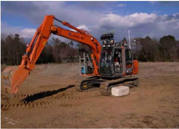
写真1 遠隔操作機能付き油圧ショベル（土研保有）
