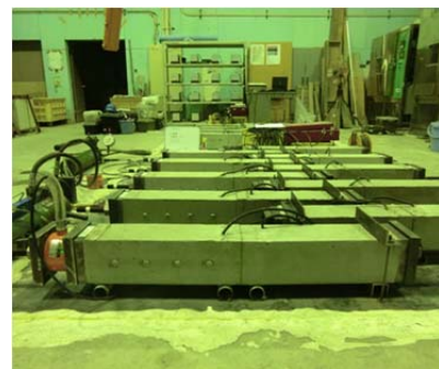
図-1 クリープ試験の供試体と圧縮力導入方法の概要
