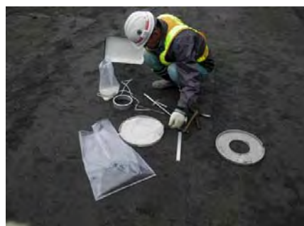
写真-3 砂置換法 (現場密度試験)
