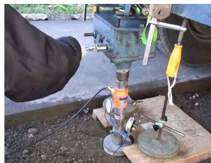
写真-4 現場 CBR 試験
