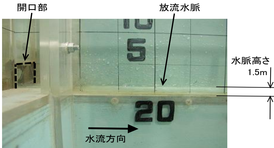
写真-3 放流水脈(貯水位 50m) (単位:m)
