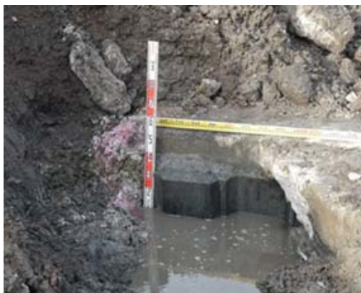
図-4.10 ウナギ止め直下の止水矢板を回り込んで注入されているグラウト材
