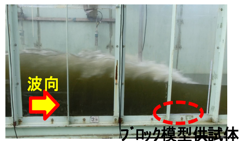
写真3 護岸ブロックへの津波作用実験
