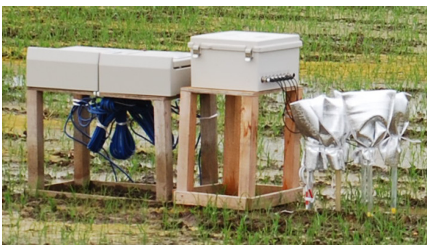
写真-3 テンシオメータ設置状況
