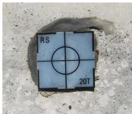
写真-2 壁面材に設置したターゲット
