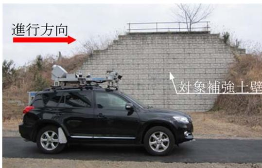
写真-5 MMS 計測状況
