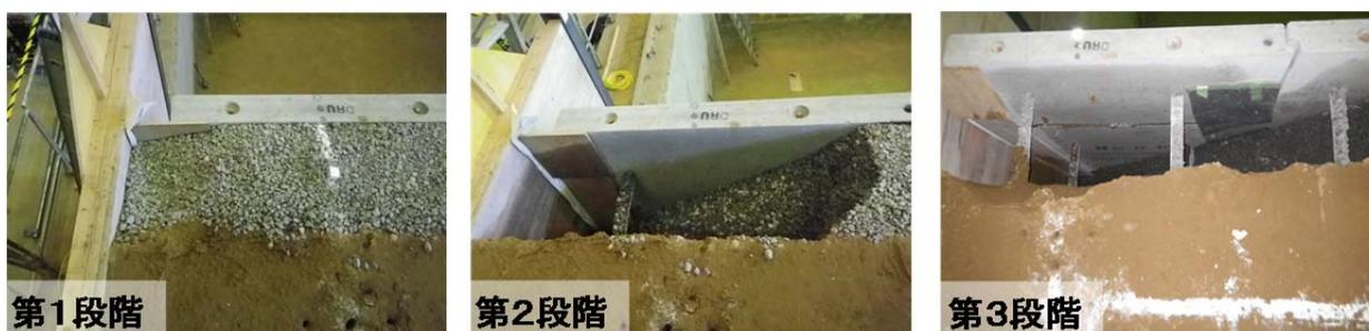
写真-19 砕石層の変形
