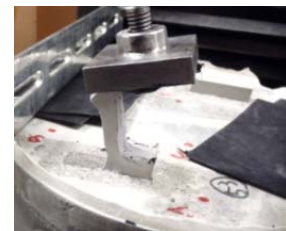
写真-6.3 付着強度試験実施状況
