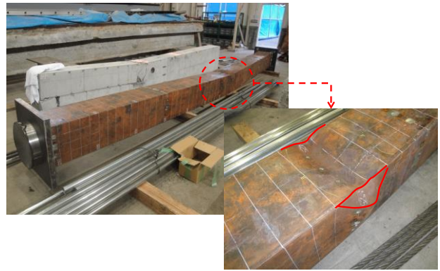
図-2.15 除荷後の試験体の変形状況 (D52u)
