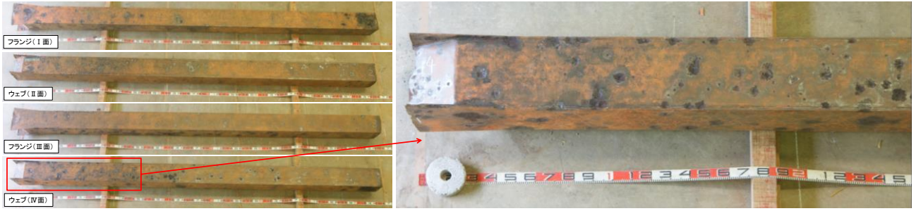
図-2.4 塗膜除去後の試験体 (D52u)
