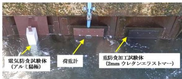
図-14 暴露試験体
