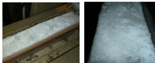
図-9 自然状態の表面部を有する自然海水の試験体
