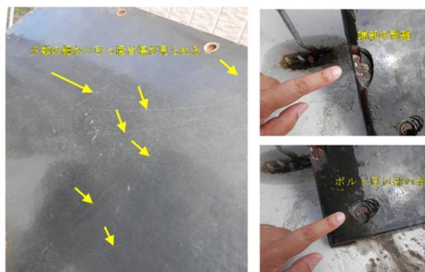
図-16 撤去後の重防食加工試験体表面状態の例
