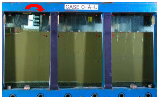
(c) 背面盛土なし 写真-5 L2加振後の変形状況 (粘性土地盤)
