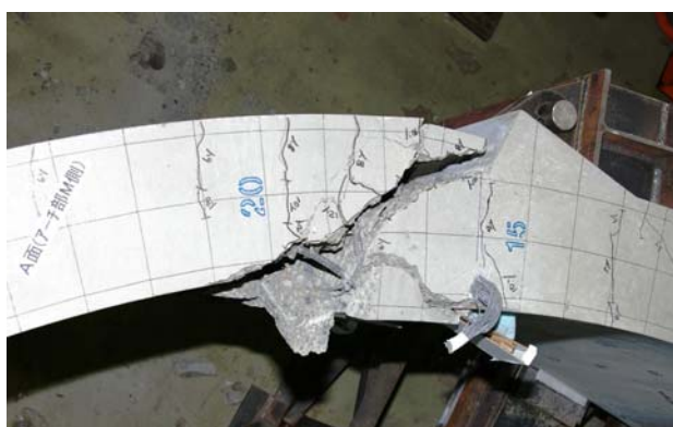
(b) アーチ肩部での曲げせん断破壊 写真-2 終局状態 (15/400 載荷後)
