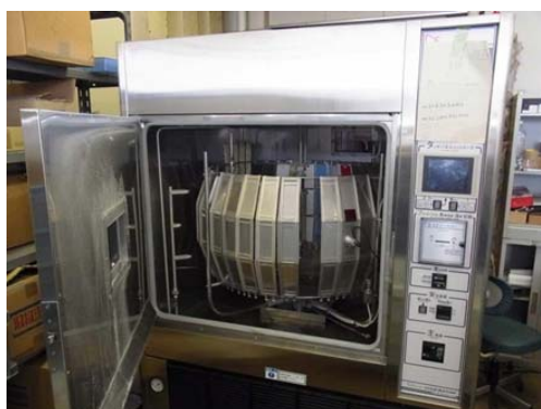
図 - 4 キセノンアークランプ式促進耐候性試験機
