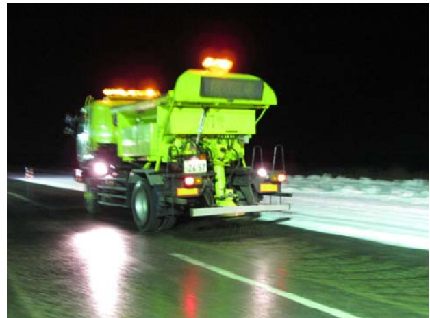
図 8 散布試験に用いた凍結防止剤散布車
