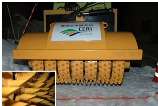
写真-10 雪氷路面処理装置の破碎部
