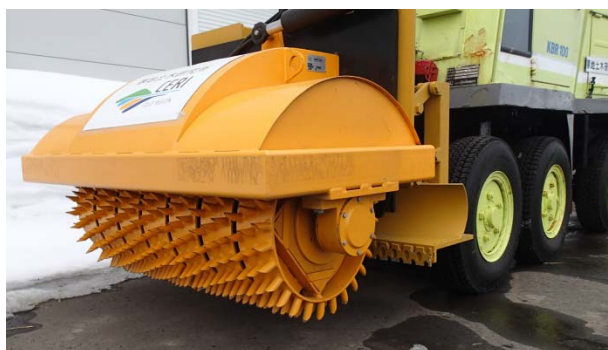
写真-3 雪氷路面処理装置の破碎部
