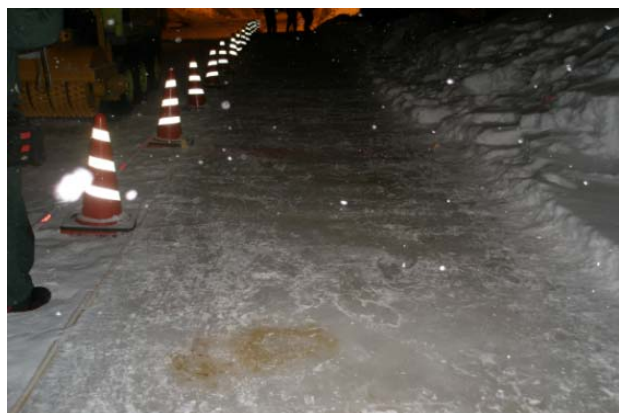
写真-13 作製した雪氷路面(氷板)
