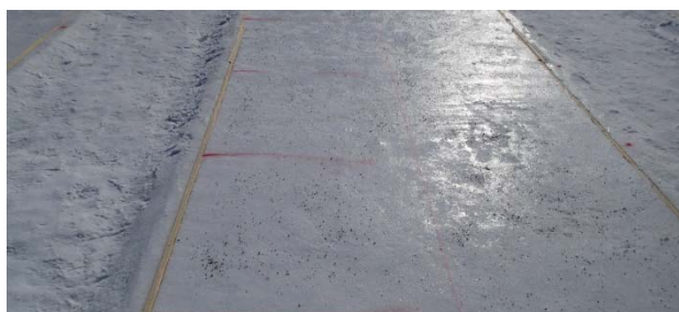
写真-16 構築したアイスバーン状況（碎石散布）
