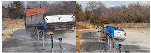
写真6 車両衝突時の状況
