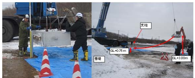
写真7 支柱衝突実験状況
