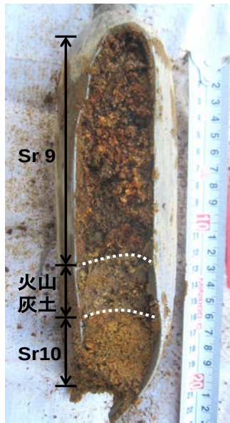
写真3 ハンドオーガーのサンプリング例
