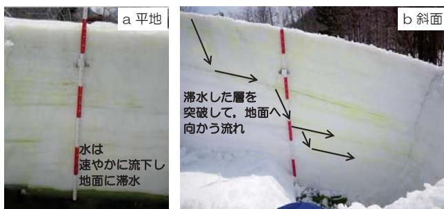
図-8 散水開始から1時間後の積雪断面
