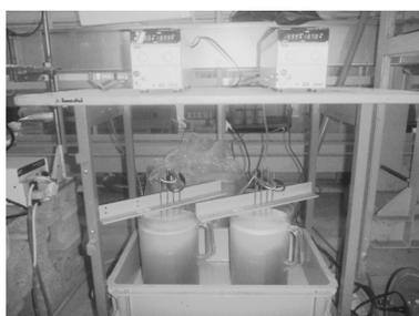
図 2-1 電気分解試験装置
