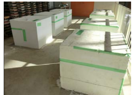
(B)発泡スチロール製の容器を用いて簡易断熱養生を行った供試体
