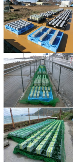
図-2 供試体の暴露状況と気象データ 2)
