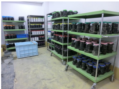
(A)温度一定の室内に保管した供試体
