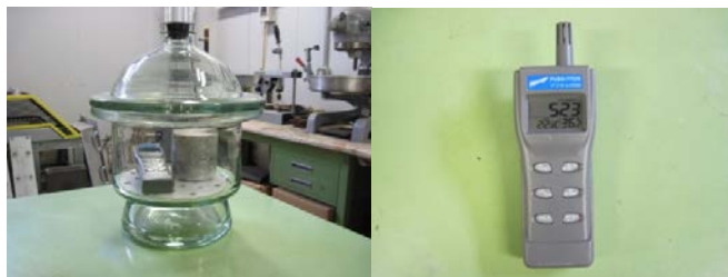
写真-3 デシケータ試験の状況 (左) と CO 2 濃度計 (右)
