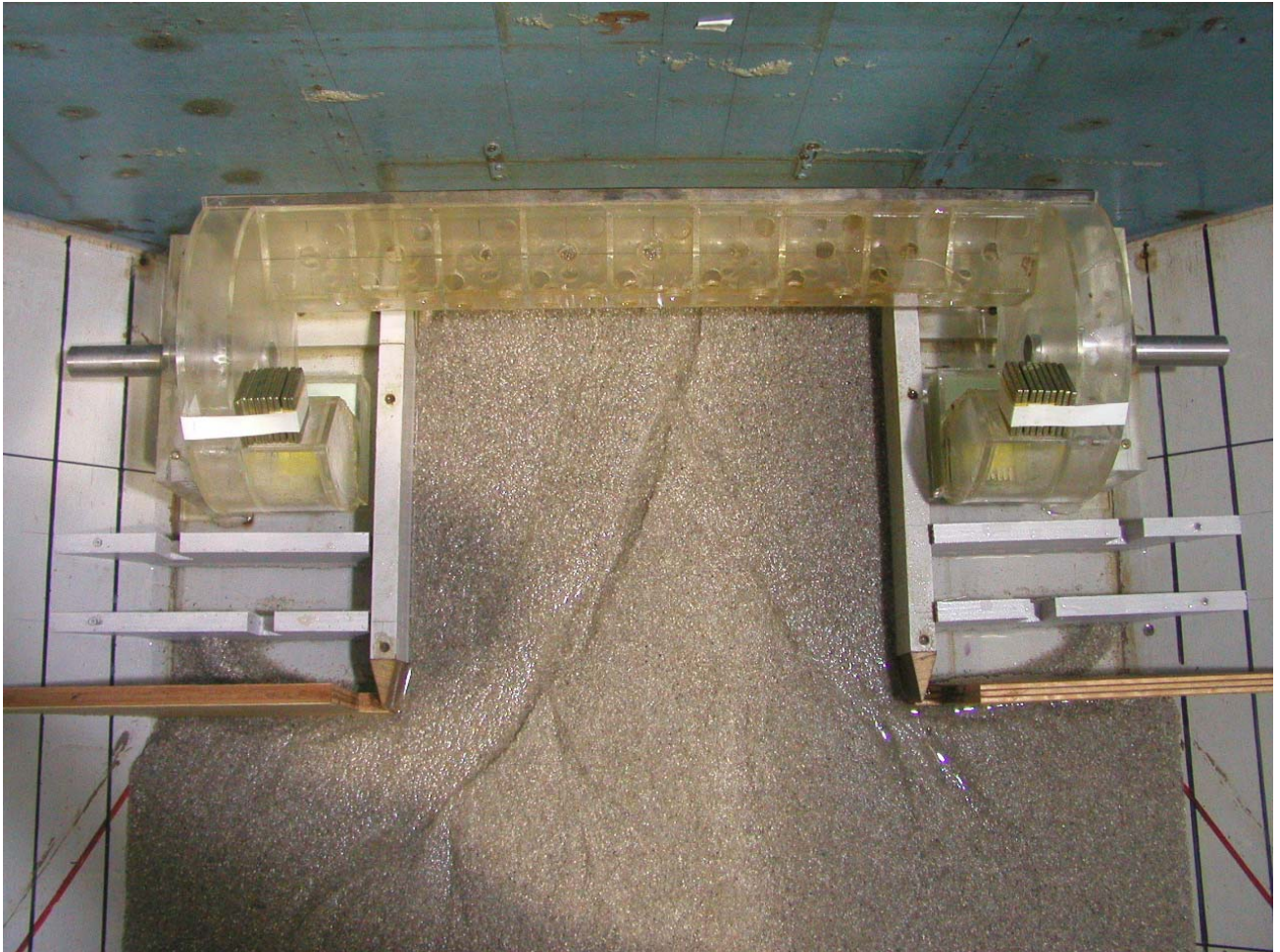
写真 3.5 土砂止め壁設置時の水位低下時土砂状況
