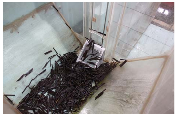
写真 3.8 流木堆積状況（スクリーン有）
