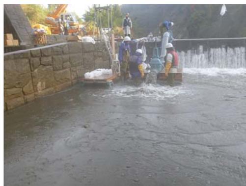
図-69 実験時排砂状況 (Case4)
