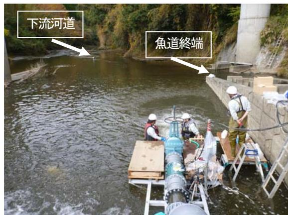
図-26 濁度計設置、計測状況 (魚道終端、下流河道)
