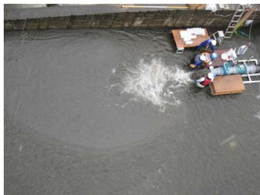
図-68 実験時排砂状況 (Case4)
