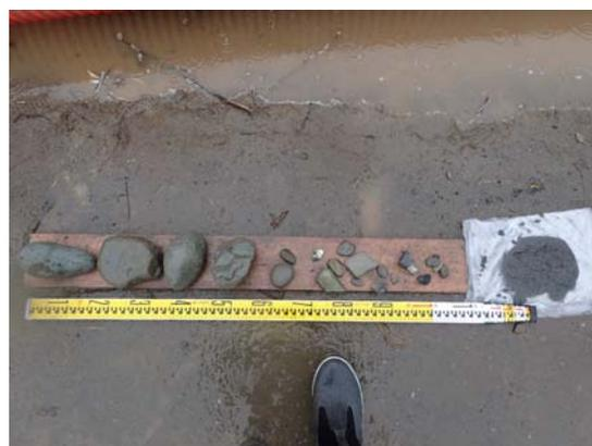
図-71 排砂土砂のサンプリング結果
