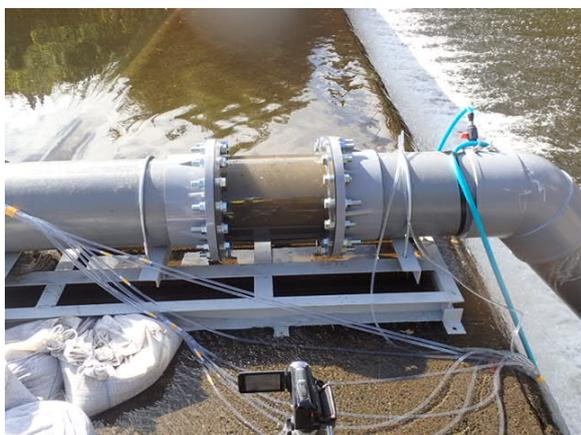
図-54 天端アクリル管での流況 (Case 3)
