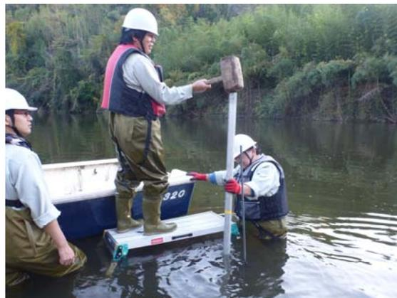
図-72 試験前 柱状サンプリング調査の状況
